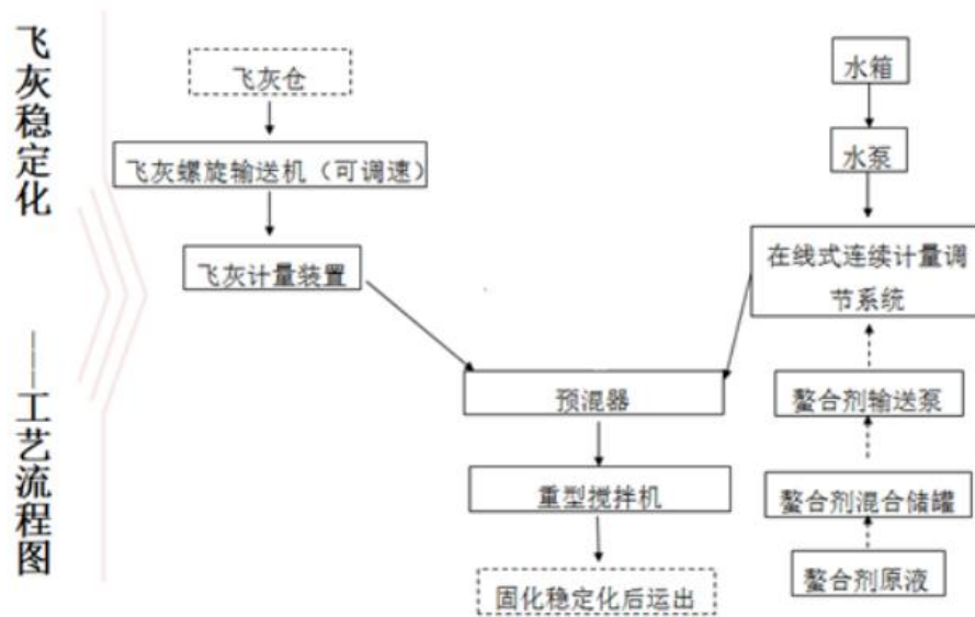
图 2.4-1 飞灰稳定化固化系统工艺流程图
